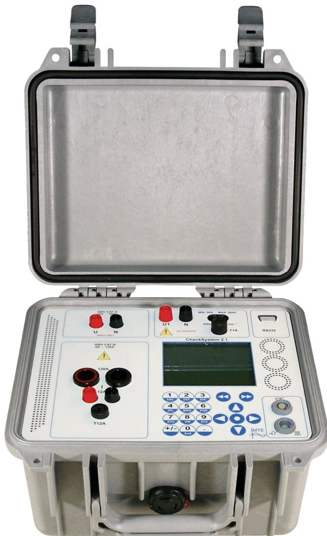
El CheckSystem 2.1 está compuesto por una fuente de intensidad monofásica y un patrón monofásico electrónico de clase 0.2. El amplio rango de medida, la alta precisión y la baja sensibilidad a interferencias externas son algunas de las características más notables del CheckSystem 2.1.
